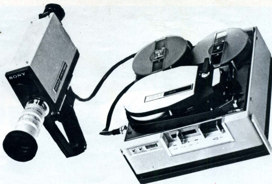
Complesso di ripresa TV-B/N portatile SONY, funziona alimentato sia in corrente continua che in corrente alternata. La telecamera, dotata di mirino elettronico, monta un tubo da ripresa Vidicon da 2/3". Il registratore video utilizza nastro magnetico da 1/2", la durata della registrazione è di 30 minuti con nastro tipo V-60H.
