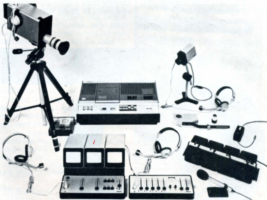
Ministudio televisivo B/N portatile della PHILIPS. Il complesso LDH 8310 rappresenta il corredo completo per realizzare programmi didattici e piccole produzioni televisive. Esso può essere considerato il punto d'arrivo dell'hobbista evoluto. Il ministudio è composto da due telecamere, un registratore video a cassetta con montaggio elettronico, un mixer video, un mixer audio, obiettivi, monitori, cuffie, microfoni, set di batterie ricaricabili ed è completo di tutti i componenti accessori d'uso.
