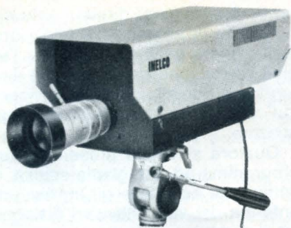
Telecamera B/N da studio costruita in Italia dalla INELCO. La ITC 500 è dotata di Viewfinder, utilizza tubi da ripresa da 1" ed è equipaggiata di circuiti audio per le comunicazioni tra regista e cameramen.
